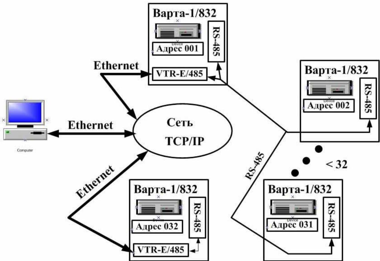
Подключение преобразователя VTR-E/485 к прибору «Варта-1/832»:
